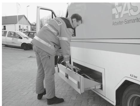
Leichtes Bergungsgerät befindet sich in einer seitlichen Schublade des Kofferaufbaus.
